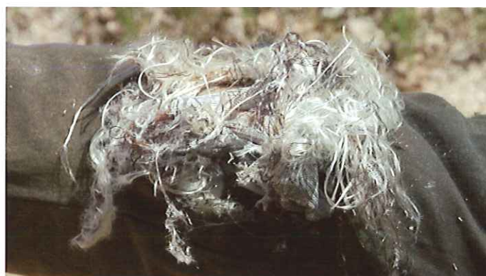
Een ingezaagde zaagbroek. De beschermende vezels zijn zichtbaar.
