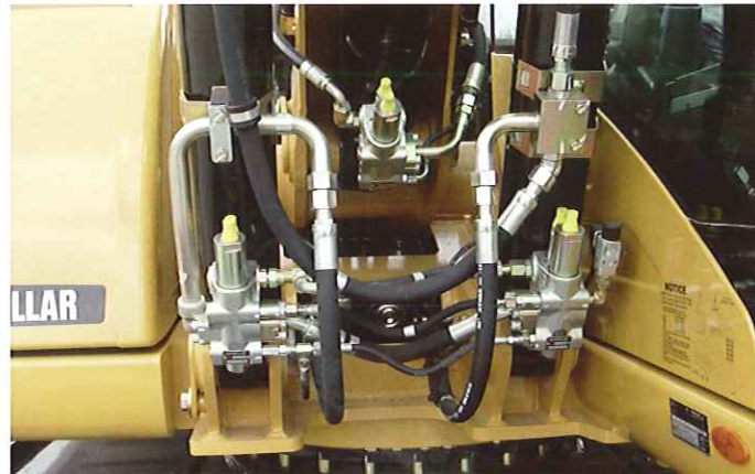
Hydraulische aansluitingen van een mobile hydraulische graafmachine met beperkte hijsfunctie.
